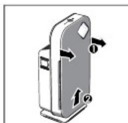
Držte drážku na dvou stranách předního panelu, vytáhněte magnetický držák dveří.
