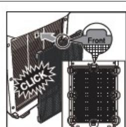
Vložte zpět před-filtr do zařízení.
