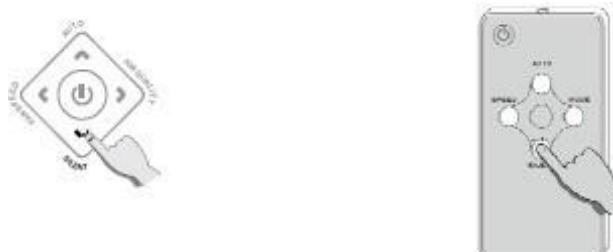
Nyomja meg a SILENT gombot, és a készülék csendes üzemmódban fog működni. A szélsebesség csendes üzemmódban csendes fokozaton lesz, és a szélsebesség-jelző kialszik. Csendes üzemmódban a SILENT jelzőfény világít.
