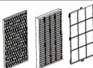
Odstraňte obalový materiál z nových filtrů a sestavu filtrů nainstalujte zpět do zařízení.
