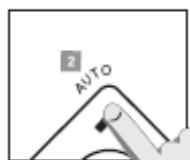
V inom pracovnom režime, stlačením tlačidla AUTO sa zariadenie prepne do automatického režimu. V AUTO režime zariadenie automaticky zvolí rýchlosť otáčok ventilátora medzi rýchlosťami 1, 2, 3 alebo 4 v závislosti od kvality vzduchu zaznamenanej snímačom kvality vzduchu a rozsvieti sa príslušná kontrolka rýchlosťi otáčok ventilátora.
