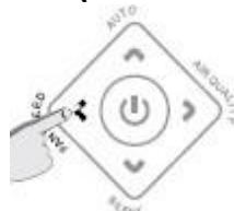
Kézi üzemmódban a ventilátor sebességét a FAN SPEED gombbal választhatja ki. Négy ventilátorsebesség áll rendelkezésre: 1. sebesség, 2. sebesség, 3. sebesség, 4. sebesség.
