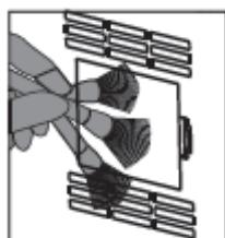
Pomocou mäkkej kefy vyčistite vstupný a výstupný otvor čističky vzduchu.
