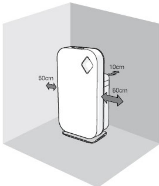
Ak sa zariadenie používa na rovnakom mieste dlhší čas, steny okolo zariadenia môžu byť znečistené. Neblokujte prívod a vývod vzduchu, aby sa zabezpečilo dostatočné vetranie a vysoká účinnosť.
