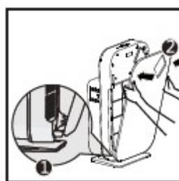
Po montáži filtrov opäťovne namontujte predný panel.
