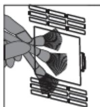
Pomocí měkkého kartáče vyčistěte vstupní a výstupní otvor čističky vzduchu.
