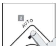
Más működési üzemmódban az AUTO gomb megnyomásával a készülék automatikus üzemmódra vált. Automatikus üzemmódban a készülék automatikusan választja ki a ventilátor sebességét az 1, 2, 3 vagy 4 sebesség közül, a levegőminőség-érzékelő által felvett levegő minőségétől függően, és a megfelelő ventilátorsebesség-jelző világít.
