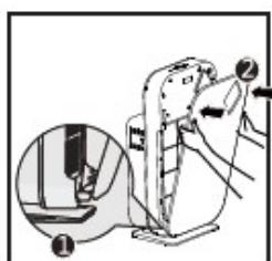
Po montáži filtrů znova namontujte přední panel.
