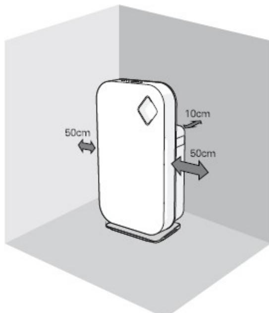
Pokud se zařízení používá na stejném místě delší dobu, stěny kolem zařízení mohou být znečištěny. Neblokujte přívod a vývod vzduchu, aby bylo zajištěno dostatečné větrání a vysoká účinnost.
