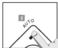
V jiném pracovním režimu, stisknutím tlačítka AUTO se zařízení přepne do automatického režimu. V AUTO režimu zařízení automaticky zvolí rychlosť otáček ventilátoru mezi rychlosťmi 1, 2, 3 nebo 4 v závislosti na kvalitě vzduchu zaznamenané snímačem kvality vzduchu a rozsvítí se příslušná kontrolka rychlosťi otáček ventilátoru.
