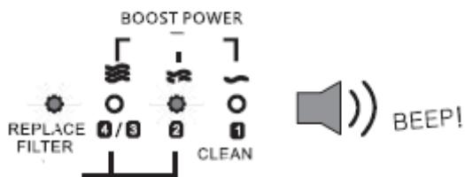
Svítí a bliká kontrolka rychlosti ventilátoru 2: je třeba vyměnit Vláknový filtr.
