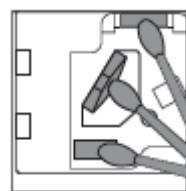
K čištění použijte vlhkou tyčinku do uší. Osušte jejich suchou bavlněnou tyčinkou. Znovu namontujte ochranný kryt senzoru kvality vzduchu.
