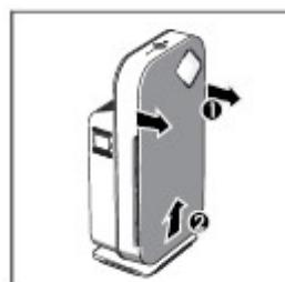
Držte drážku na dvoch stranach predného panela, vytiahnite magnetický držiak dverí.
