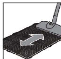
Odstraňte částečky vysavačem. Vyčistěte před-filtr vodou (mýdlem) a nechte vyschnutí.
